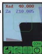
Medición del filo de la herramienta
