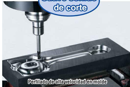
Fresado profundo en molde (Acero pre-templado)
