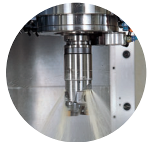
Refrigeración interna de alta presión
